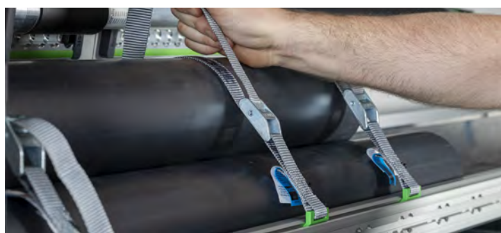
C-Lash - das innovative Ladungssicherungssystem in der bott vario3 Fahrzeugeinrichtung
